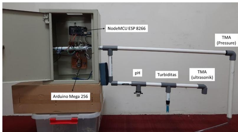
Gambar 58. Rangkaian prototipe instrumen monitoring hidrodinamika
