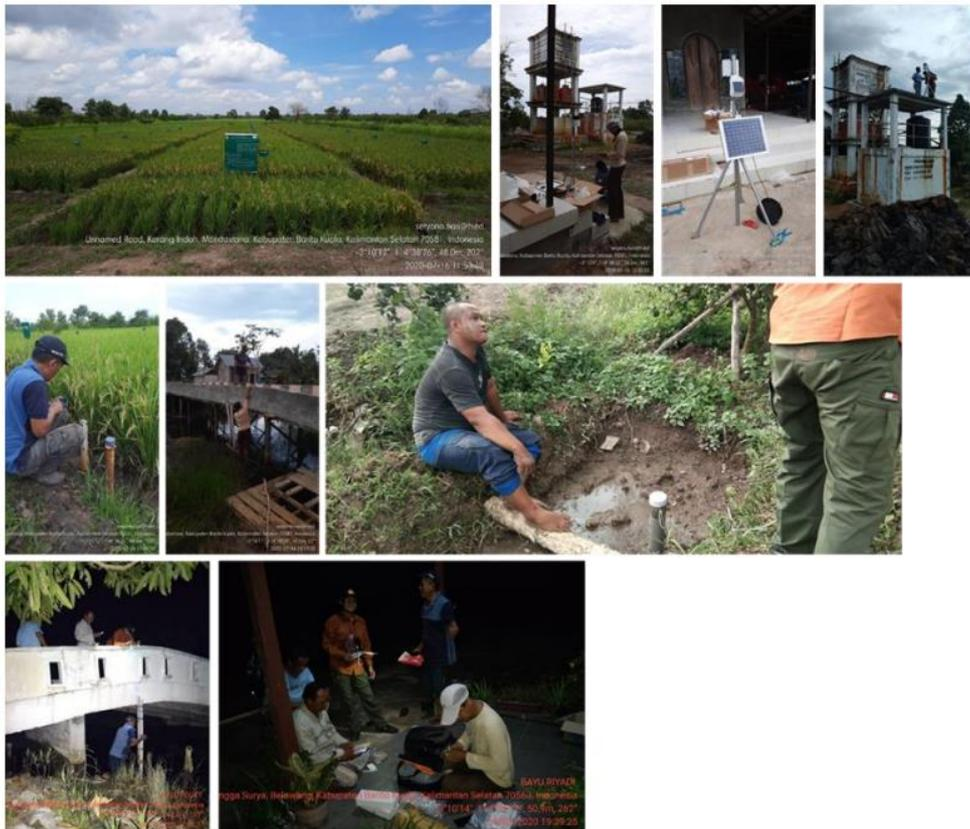
Gambar 2. instalasi instrumen perekam data hidrodinamika di demfarm Puntik Dalam, Kalimantan Selatan
